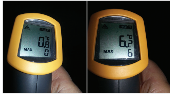
겨울철 단열막(알린) 적용 전 유리창 표면온도 측정(좌)과 단열막(알린) 적용 후 표면온도 측정(우)
