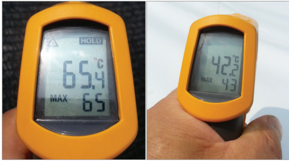
여름철 단열막을 적용하기 전 차광막지붕 온도 측정(좌)과 단열막을 적용한 계사지붕 온도 측정(우)
